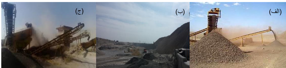
شکل ۱. تولید گردوغبار در معادن شن و ماسه در هنگام فرایندهای مختلف. الف) تولید غبار در اثر تردد کامیون‌ها در جاده‌های خاکی داخل معدن و نیز ناشی از سایش قطعات و سوخت آنها. ب و ج) تولید غبار هنگام الک کردن و خردایش در معادن شن و ماسه (۱۱، ۱۰).
