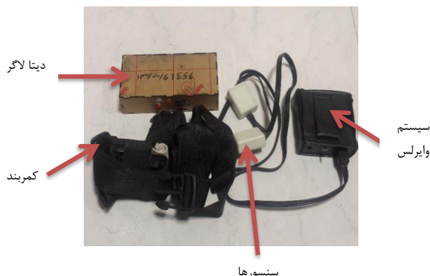
شکل ۱. الف) دستگاہ آنالیز حرکتی طراحی شده، ب) استفاده از دستگاہ آنالیز حرکت در صنعت خودروسازی
