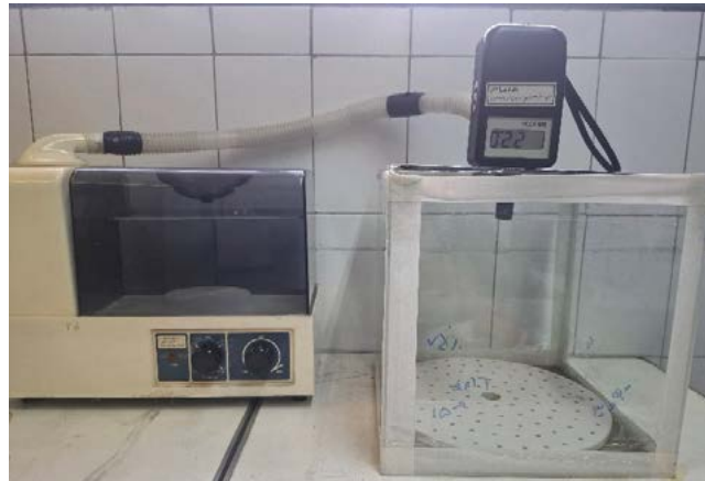
شکل ۱: تصویر اتاقک طراحی شده جهت تولید محیط مرطوب متصل به دستگاه بخور
