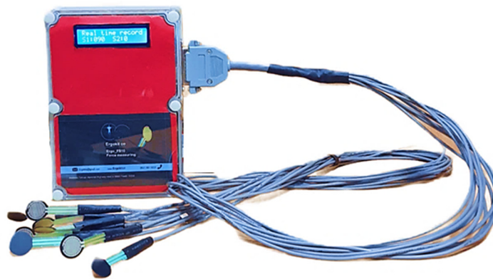
شکل ۲: دستگاه سنجش فشار تماسی (ErgoFs16)
