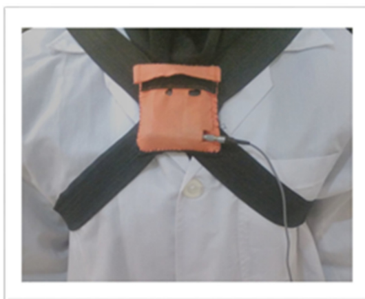
شکل ۲: تصویر دستگاه شیبسنج حین اندازه‌گیری
