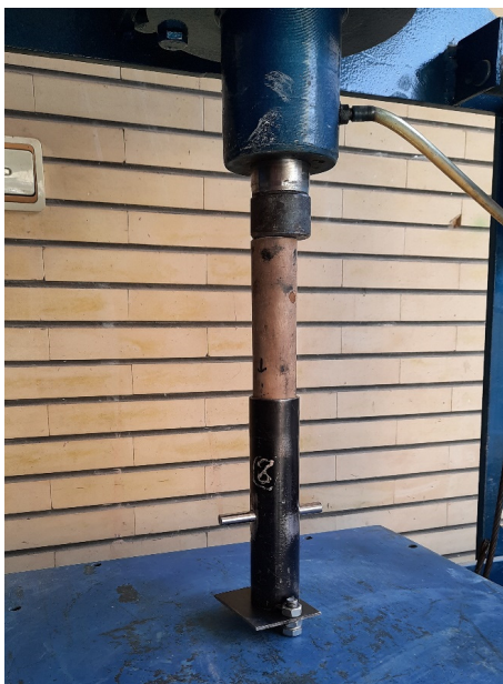
شکل ۱: قالب ۳۰ میلی‌متری زیر پرس هیدرولیک
