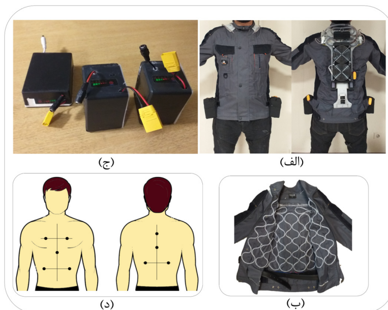
شکل ۴: (الف) تصویری از LCG بر تن سوژه آزمودنی (ب) منابع تغذیه قابل حمل (ج) الگوی سیستم لوله‌کشی LCG (د) شماتیک نقاط اندازه‌گیری دما در نواحی مختلف میکرو اقلیم
