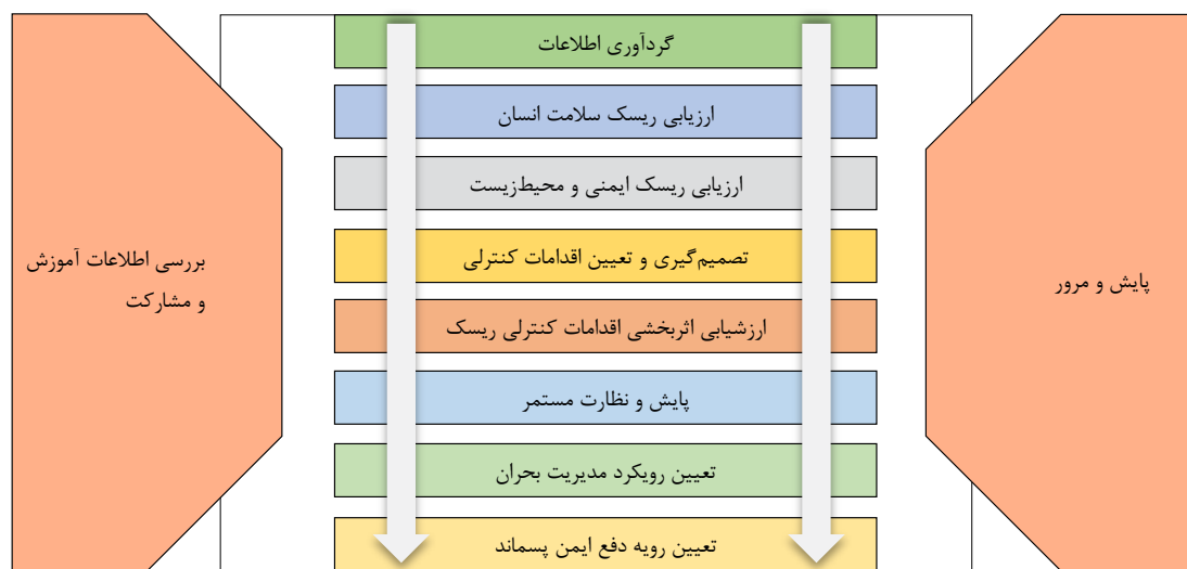
شکل ۳: فرآیند کلی توسعه یافته در مدیریت ریسک نانومواد مهندسی‌شده (۴۹، ۵۰)
