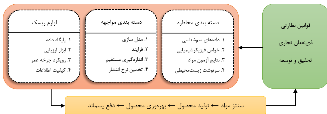
شکل ۴: ساختار پیشنهادی یک چارچوب جامع برای مدیریت ریسک نانومواد مهندسی‌شده
