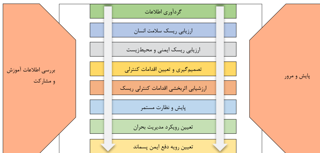
شکل ۳: فرایند کلی توسعه یافته در مدیریت ریسک نانومواد مهندسی‌شده (۴۹، ۵۰)
