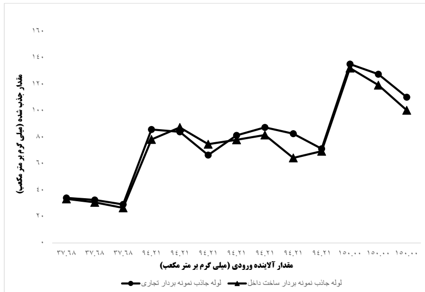
شکل ۴: مقدار جاذب لوله های جاذب نمونه بردار ساخت داخل و نوع تجاری در تراکم های مختلف از تولوئن
