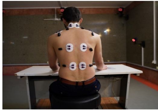
شکل ۱: محل قرارگیری الکترودهای دستگاه الکترومایوگرافی در پژوهش حاضر
