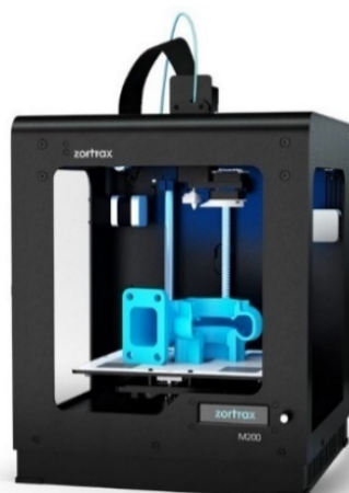
شکل ۱. دستگاه پرینت سه بعد مدل M200 ساخت شرکت Zortrax لهستان (۴۲)
