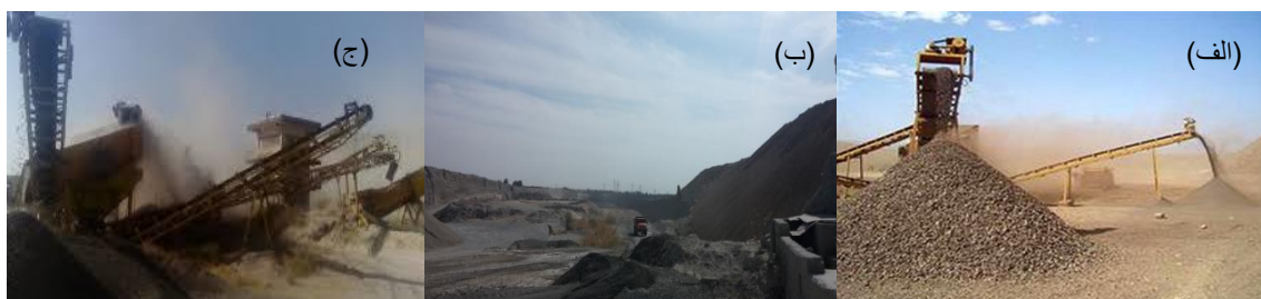
شکل ۱. تولید گردوغبار در معدن‌شن و ماسه در هنگام فرایندهای مختلف. الف) تولید غبار در اثر تردد کامیونها در جاده‌های خاکی داخل معدن و نیز ناشی از سایش قطعات و سوخت آنها. ب و ج) تولید غبار هنگام الک کردن و خردایش در معدن‌شن و ماسه (۱۱، ۱۰).
