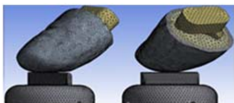
شکل ۲: شبکه بندی مدل انگشت شست و کلیپس
