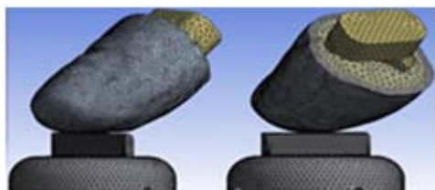
شکل ۲: شبکه بندی مدل انگشت شست و کلیپس
