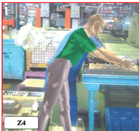
شکل ۴: نتایج اصلی 3DSSPP و Catia برای پوسچر Z4 از وظیفه شماره ۲
