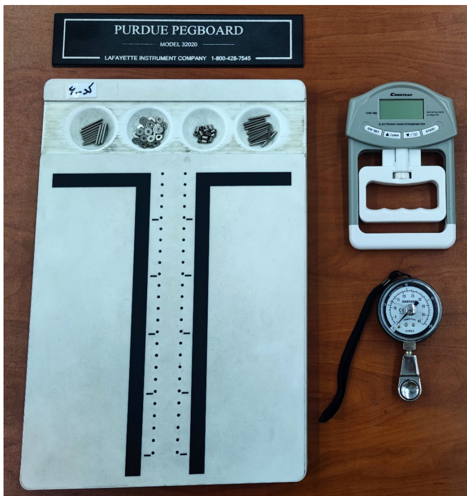
شکل ۱: ابزارهای مورد استفاده، چپ: آزمون پگبورد، راست بالا: دینامومتر دیجیتال، راست پایین: چنگش ظریف
