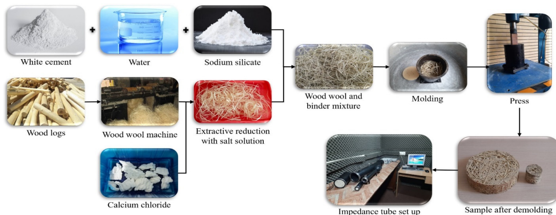
شکل ۱: فلوچارت ساخت نمونه‌ها و اندازه‌گیری ضریب جذب
