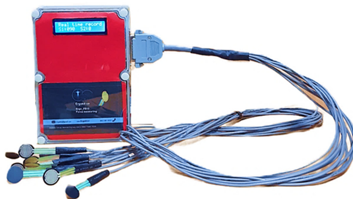
شکل ۲: دستگاه سنجش فشار تماسی (ErgoFs16)
