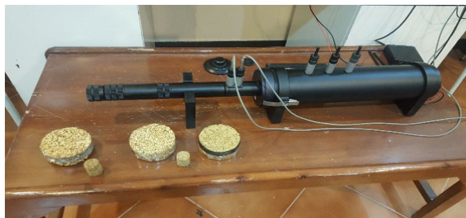
شکل ۳: نمای لوله امپدانس دو میکروفون
