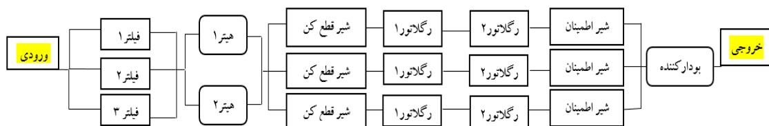
شکل ۳: تجهیزات اصلی ایستگاه تقلیل فشار گاز شهری CGS
