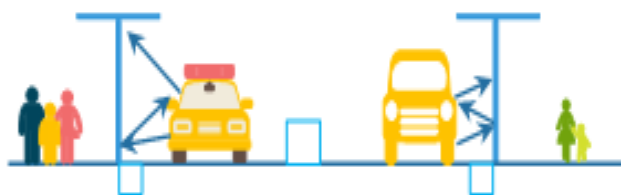
شکل ۱. بازتاب بین ماشین در حال حرکت و مانع
