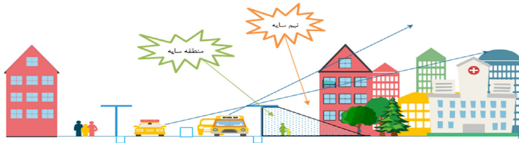
شکل ۲. عملکرد مانع T شکل در دو منطقه سایه و نیم سایه
