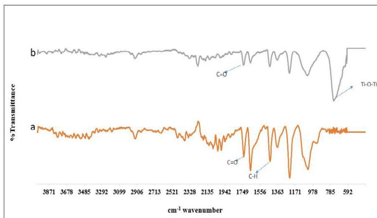
Fig 2. FTIR of a: PAN , b: PAN/TiO<sub>2</sub> nanofibers
