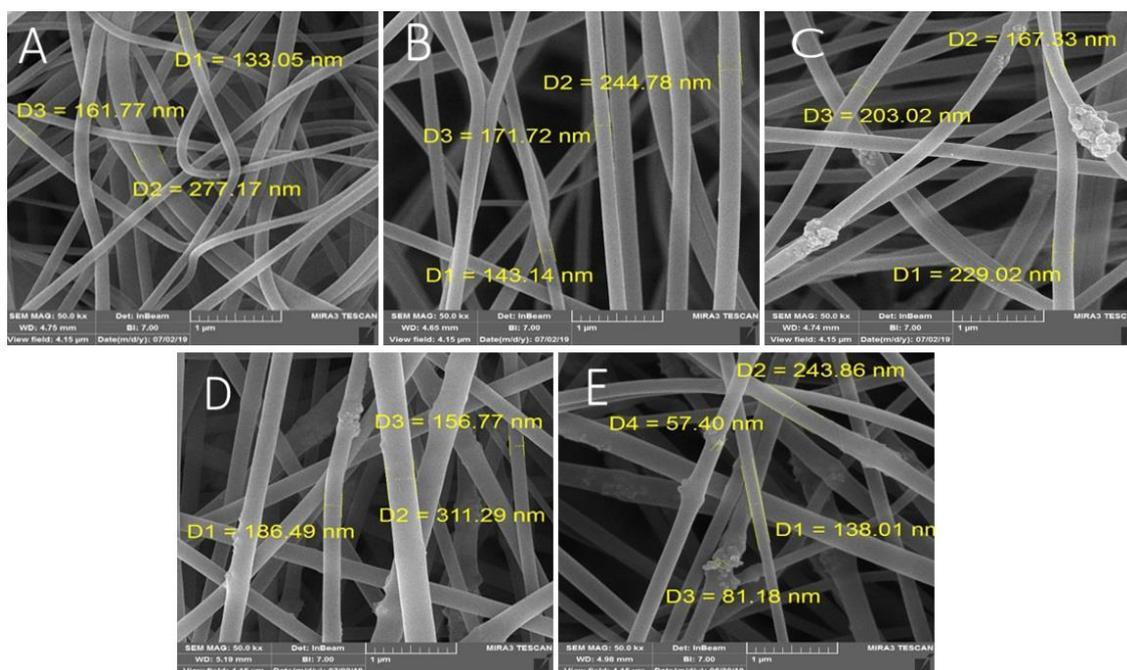
Fig 1. SEM images of A: PAN, B: PAN/TiO<sub>2</sub>(%1), C: PAN/TiO<sub>2</sub>(%5), D: PAN/TiO<sub>2</sub>(%10), E: PAN/TiO<sub>2</sub>(%15)
