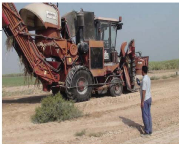
شکل ۱: حرکت دستگاه و موقعیت میکروفن (ISO7216)
