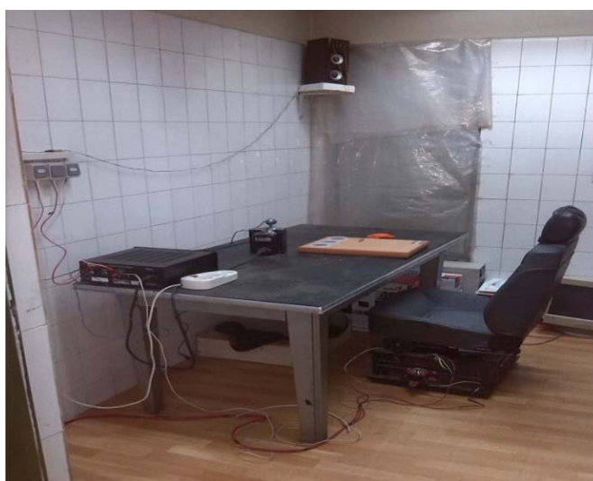
تصویر ۱. دستگاه شبیه ساز ارتعاش تمام بدن
