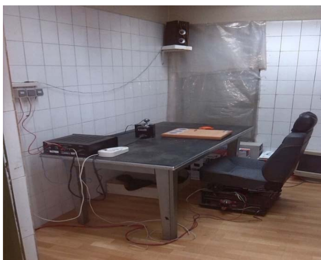
تصویر ۱. دستگاه شبیه ساز ارتعاش تمام بدن
