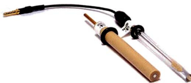
شکل ۱. نمایی از یک سنسور جهت استفاده در سیستم سه الکتروودی برای تعیین مقدار آنالیت به روش ولتامتری
