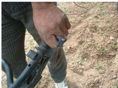
شکل ۵: نصب مبدل UA 0894 جهت اندازه‌گیری ارتعاش در جهات X، Y و Z
